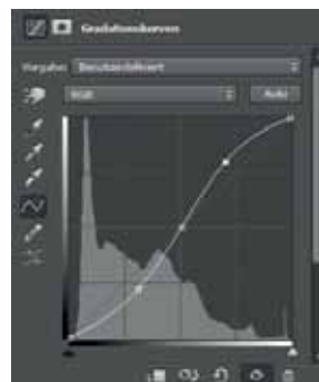
Kontraststeigerung in den Mittelönen ohne Beschnitt in Tiefen oder Lichtern
