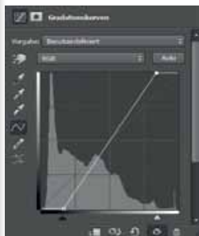
Kontraststeigerung durch steilen Kurvenverlauf. Zeichnungsverlust in Tiefen und Lichtern.
