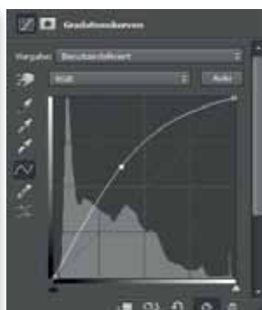
Wird der Kontrollpunkt nach oben verschoben, so werden alle Tonwerte aufgehellt.
